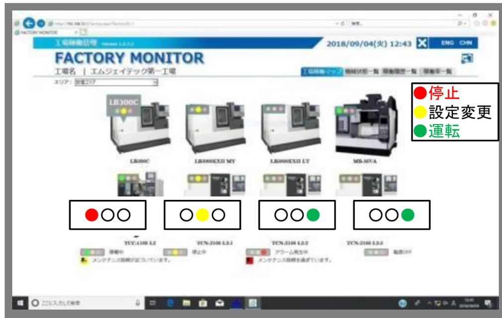
稼働モニタリングソフトの画面 接続されている工作機と状態が表示(イメージ)
