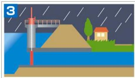
樋門の扉を閉めると、住宅側の水の行き場所がなくなり、住宅地が浸水する（内水被害）場合があります。そのため、内水被害が発生する場所には排水機場を設置したり、排水ポンプ車で排水するなどの対策を講じています。
