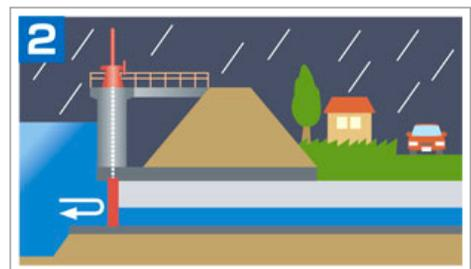
洪水により川の水位が高くなると、川の水が樋門を通して住宅側に流れ込み（逆流）、浸水被害が発生するため、樋門の扉を閉めます。
