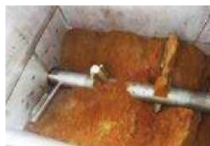
処理槽内部（メインシャフトと攪拌棒）
