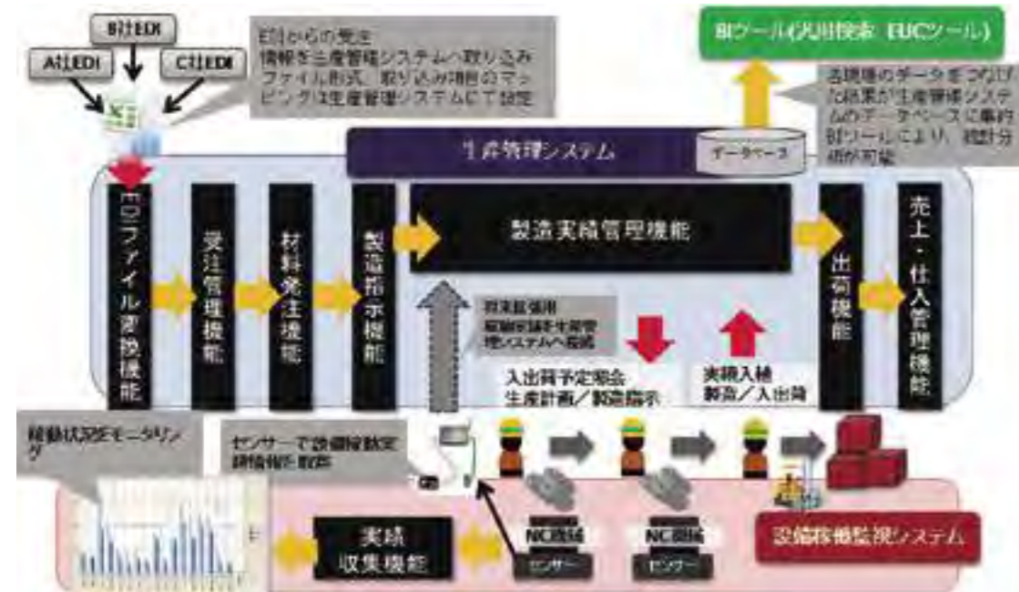
◇設備機械アラーム履歴の管理 生産管理システム構築図
